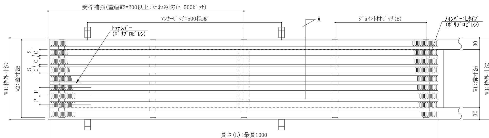
受枠補強(蓋幅W2=200以上:たわみ防止 500ピッチ)
