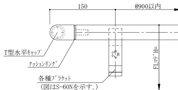
K型水平キャップ<sup>®</sup> (被せタイプ) 端部納まり 展開図
